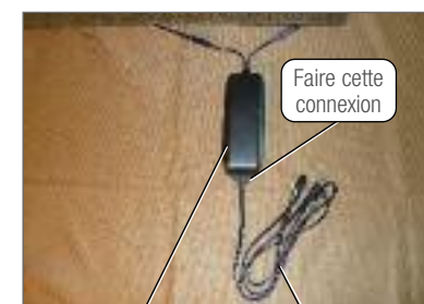
Transformateur électrique Cordon électrique de 120 volts
