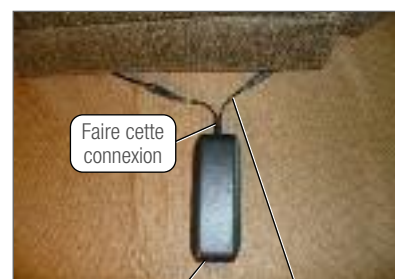
Transformateur électrique Petit câble en Y
