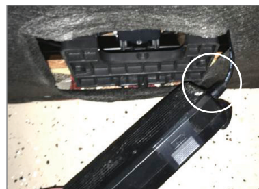
Brancher le connecteur du moteur sur l'alimentation électrique
