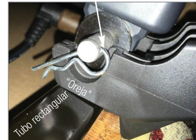
La flecha muestra el tope de la "oreja" en el conector del motor
