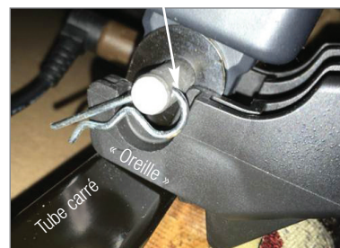
La flèche indique l'« oreille » s'arrêtant sur le pignon du moteur
