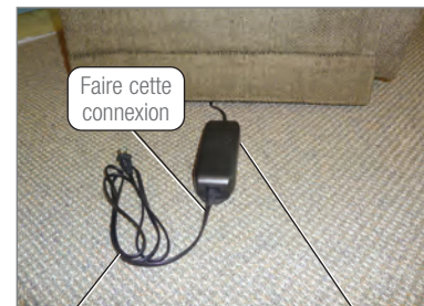
Cordon électrique de 120 volts Transformateur électrique
